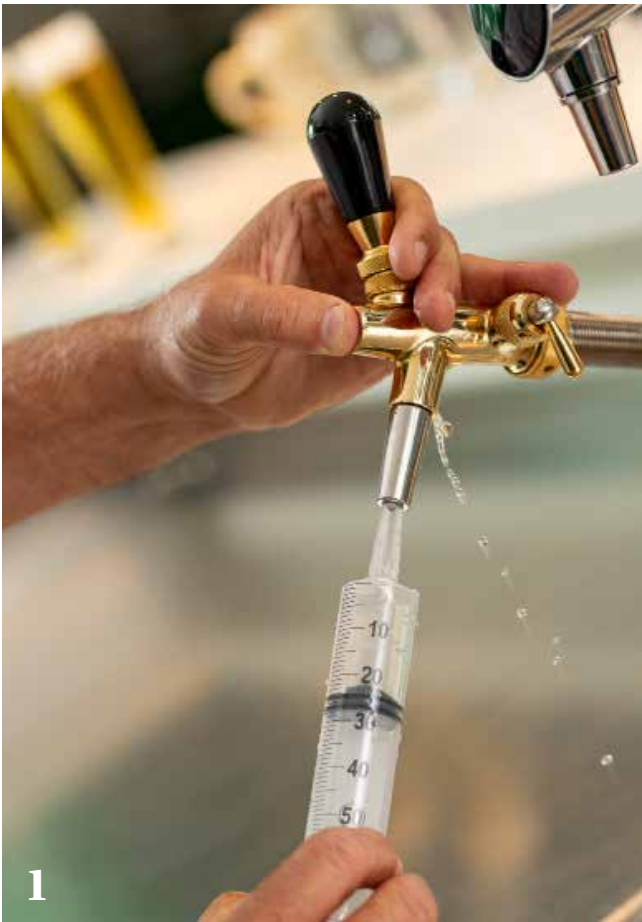
1 Der Zapfhahn wird mit einer Spritze gereinigt. 2 Bevor Bier ins Glas fließt, dieses unbedingt kalt ausspülen. 3 Drei Python-Modelle, durch die das Bier vom Fass zur Schank gelangt.
